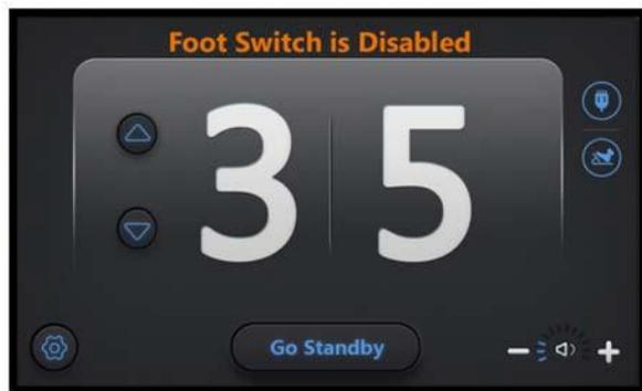
La pédale de commande est désactivée. En mode "Prêt", l'appui sur la pédale est détecté.
