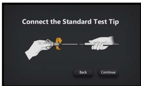
Rappel de l'écran avant d'exécuter "Test Hand Piece with Test Tip". Avant le test, il rappelle à l'utilisateur d'assembler la pointe de test à la pièce à main et de la serrer. Touchez "Continuer" pour exécuter le test, ou touchez "Retour" pour revenir à l'écran des paramètres.
