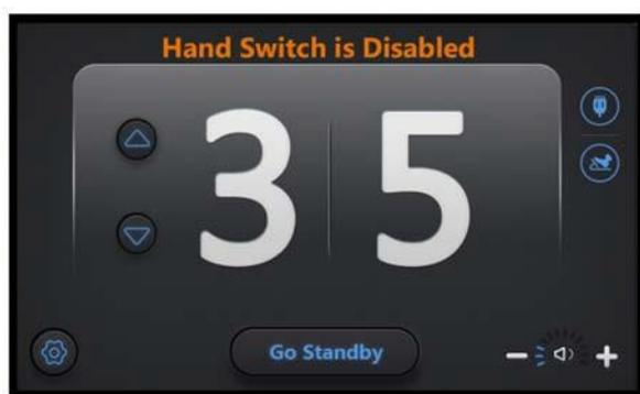
L'interrupteur à main est désactivé. En mode "Prêt", la pression sur le bouton de l'interrupteur manuel est détectée.
