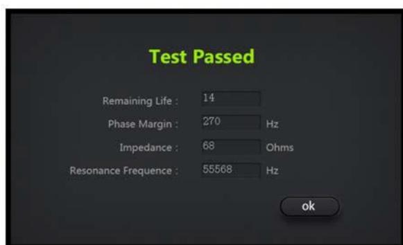
Les résultats du test s'affichent après l'exécution de "Test Hand Piece with Test Tip". Il indique les utilisations restantes de la pièce à main actuelle. Il indique également la marge de phase, l'impédance et la fréquence de résonance.
