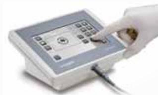
Pratique et conviviale : la télécommande marTouch® contrôle les éclairages opératoires et le système de caméra surgiCam® et permet à l'utilisateur d'obtenir de nombreuses autres informations. Y compris station d'accueil, avec fixation sur table ou murale.
