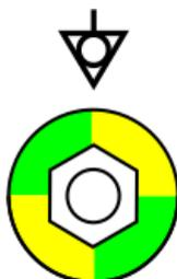
L'appareil peut être raccordé sur la broche de compensation de potentiel via le câble de compensation de potentiel (compris dans la livraison) avec le raccordement de potentiel dans le bloc opératoire.
