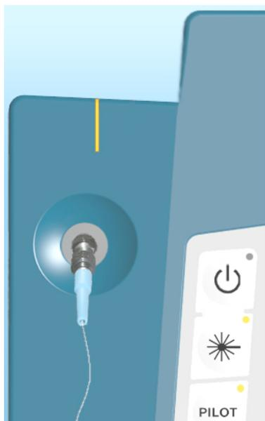
La **douille de raccordement de fibre SMA-X** sert à raccorder les fibres laser avec la prise mâle SMA-X. La position de la prise de fibre est surveillée électroniquement.
